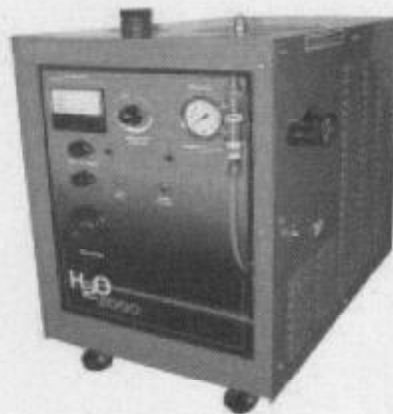
Kommerzieller Klein-Gasgenerator mit 5 kW Leistungsaufnahme mit Langzeitstabilität.
